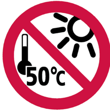
図 9ー “50 °C以上の高温又は長時間日光に絶対にさらさない” シンボル
