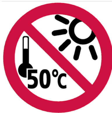
図 7—“50 °C以上の高温又は長時間の日光には、絶対にさらさない”のシンボル
