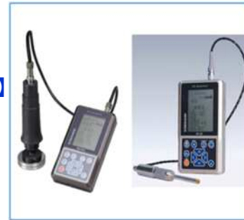
超音波接触インピーダンス(UCI)硬さ測定方法のイメージ
