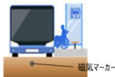
磁気マーカーによるバス停等における正着制御のためのインフラからの支援
