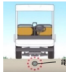
電磁誘導線による 路車連携型支援
