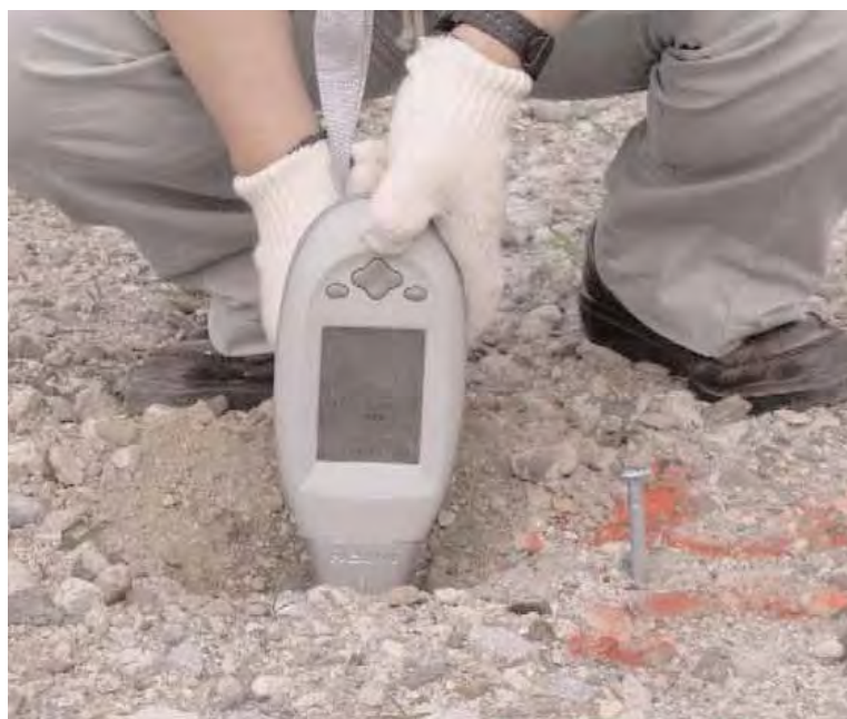
ポータブル型蛍光X線分析器による土壌調査の様子
