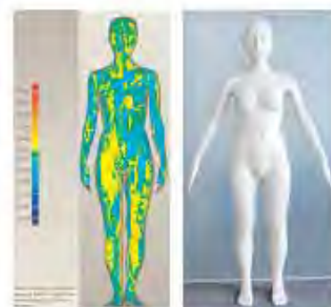
トレーサビリティを考慮した人体形状測定と精度評価用ゲージとしての人体ダミー
