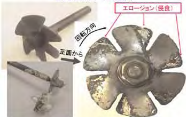
フローソルダーリング(ウェーブソルダーリング)機器に使用されるウェーブ発生用回転ブレードの損傷例
