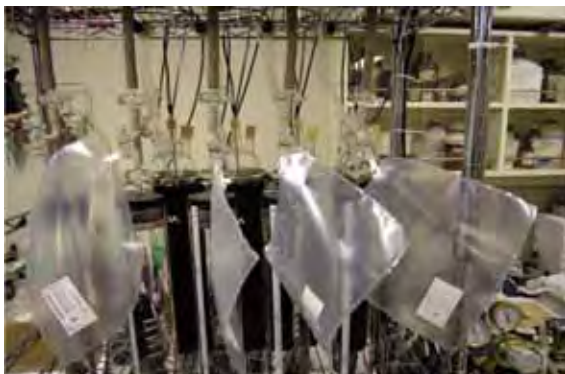
微生物嫌気分解試験装置（MODA-B）
