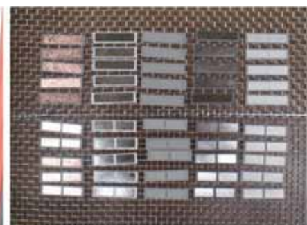
(c)残存強度用試験片
